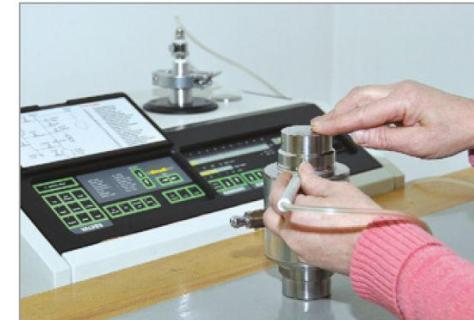
Надежность вагонных весов во многом обеспечивается высокой надежностью датчиков MB-150. Они имеют герметичный корпус из нержавеющей стали с наивысшей степенью защиты IP 68 по ГОСТ-14254.
